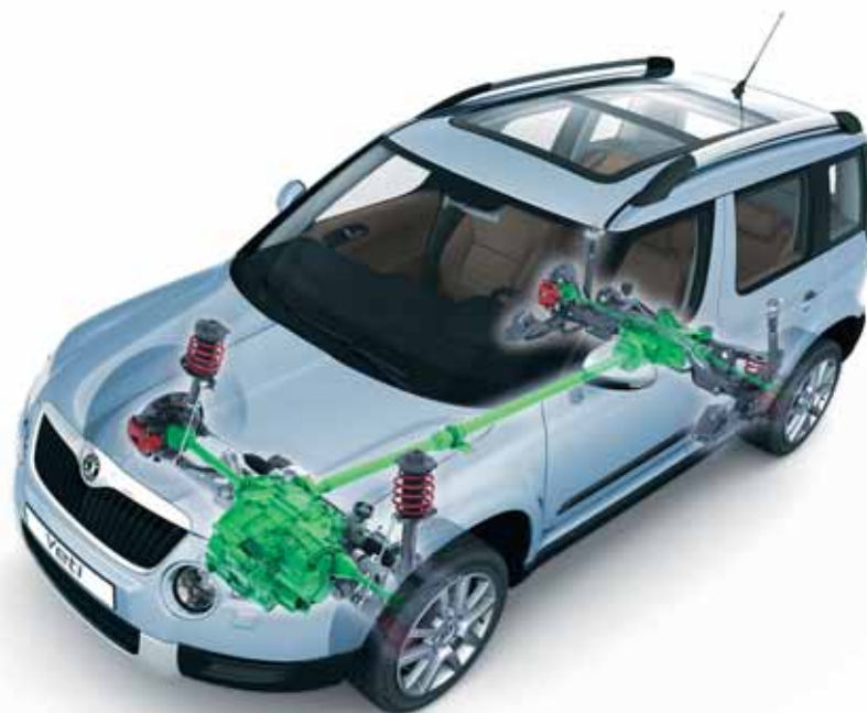
Škoda Yeti s pohonom 4x4 a so spojkou Haldex 4. generácie (motorizácie 1,8 TSI/118 kW a 2,0 TDI CR DPF/81 kW; 103 kW a 125 kW)
