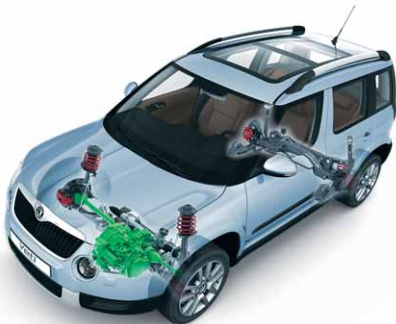
Škoda Yeti s pohonom predných kolies (motorizácia 1,2 TSI/77 kW a 2,0 TDI CR DPF/81 kW)
